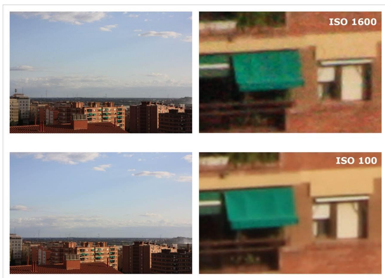
Figura 34. Efecte del valor ISO en la qualitat d'imatge. A l'esquerra les imatges originals i a la dreta les ampliacions respectives; a dalt a sensibilitat alta (1600 ISO) i a baix baixa sensibilitat (ISO 100). Es pot observar que la diferència és apreciable.
