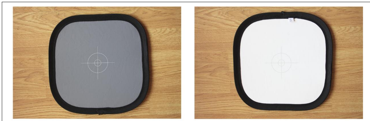
Figura 5. Carta gris i blanca utilitzada per a la mesura manual de l'exposició i per al calibratge personalitzat del balanç de blancs.
