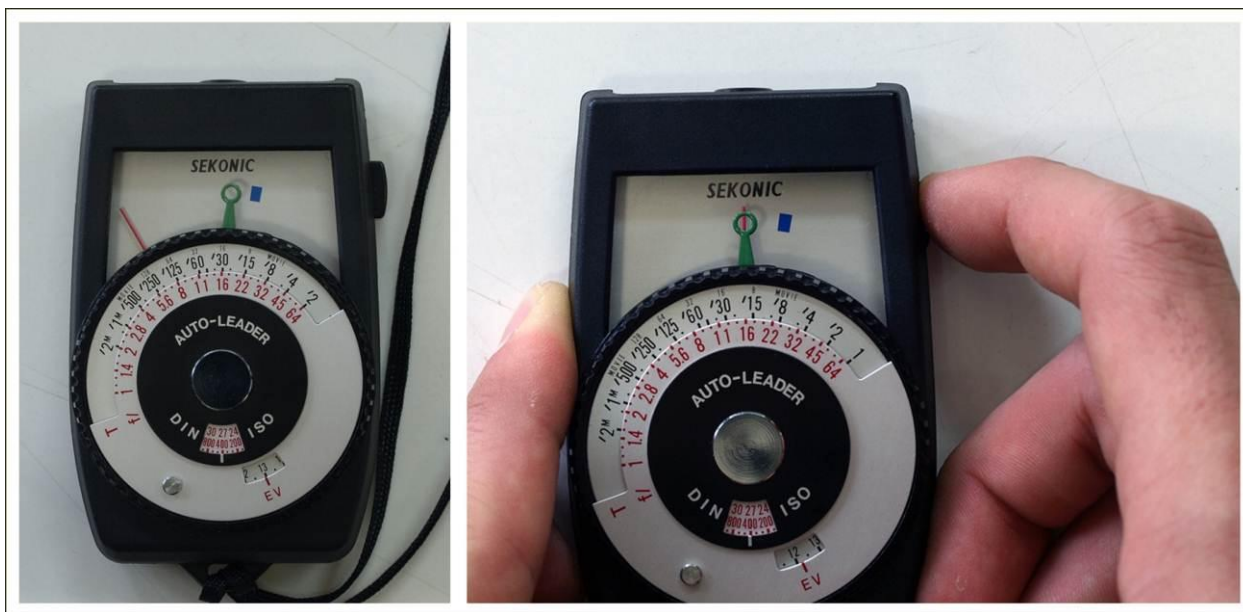
Figura 4. Fotòmetre manual utilitzat per comprovar com varien els paràmetres del "triangle fotogràfic". A l'esquerra es mostra l'aparell sol, sense activar. A la dreta es veu com quan s'activa (prement el botó de la dreta), l'agulla vermella es desplaça i s'ha de fer coincidir (movent la roda de la velocitat) amb el centre de la marca de color verd, aleshores, per a un determinat valor ISO, podrem veure totes les combinacions de velocitat (números negres, anella gran) i de diafragma (números vermells, anella gran) que donaran una exposició correcta.
