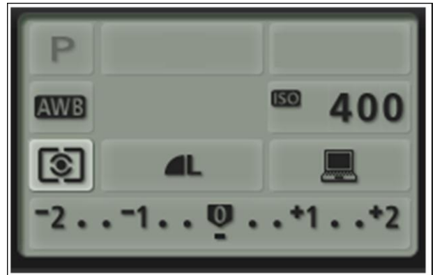
Figura 7. En la pantalla de la càmera se'ns mostra una imatge com aquesta que ens permet modificar l'exposició manualment, quan la càmera està en mode P, Av, Tv, o M.
